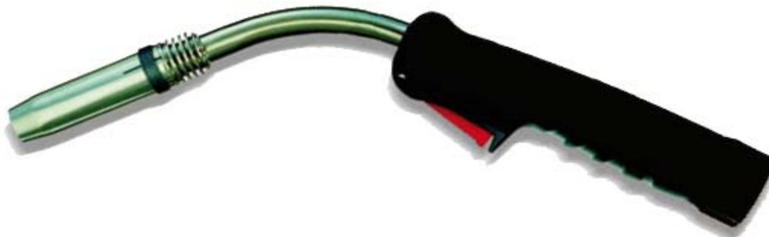
La torcia per saldatura MIG/MAG viene utilizzata quando è richiesta un'alta produttività ed una sufficiente flessibilità di impiego. Con questa tecnologia è possibile saldare acciai sia austenitici sia ferritici, leghe di metalli leggeri (Al e Mg), leghe di rame, leghe di nickel e leghe di titanio.
