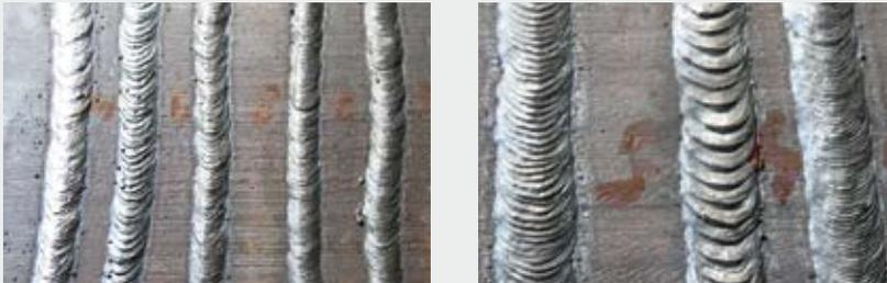
Fig.B Aspetto del cordone fatto con elettrodo cellulosico.
